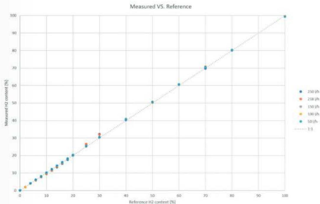
ofrece Mems AG es económica y fácil de ejecutar. La instalación de un dispositivo gasQS estático en la línea de gas mezclado permite determinar la conductividad térmica del gas y correlaciona a partir de ella el índice de Wobbe correspondiente. El valor de salida se transmite con una señal 4-20 mA.
